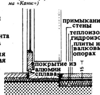
11. Примыкание стены на участке двери на террасу
