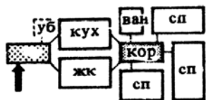
3. Схема взаимосвязи помещений в квартире дома с расположенным в средней зоне коридором, из которого можно пройти непосредственно в жилую комнату и кухню, в спальню и ванную. Квартиры, запроектированные по этой схеме, экономичны и удобны в эксплуатации.
