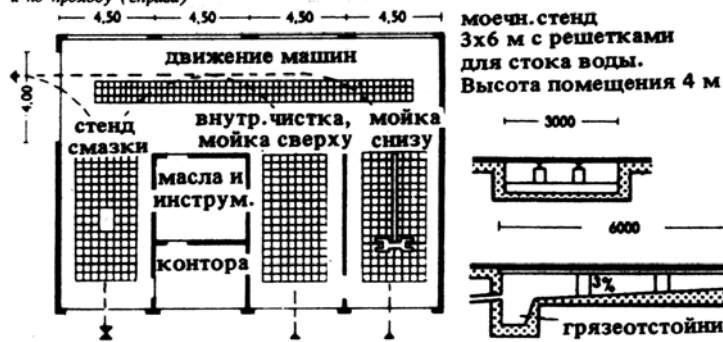
6. Пост скорой технической помощи со сквозным движением
