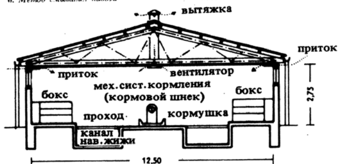
8. Поперечный разрез здания коровника для беспривязного содержания скота в боксах, оснащенного шнеком для подачи корма и каналом для удаления навозной жижи
