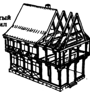
10. В местностях, бедных лесом, применяют каркасную конструкцию. Жесткость обеспечивают распорки под окнами
