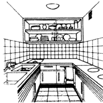
3. Минимальная кухня с вытяжкой и приточной вентиляцией (архит. Нойферт). Перспектива и план
