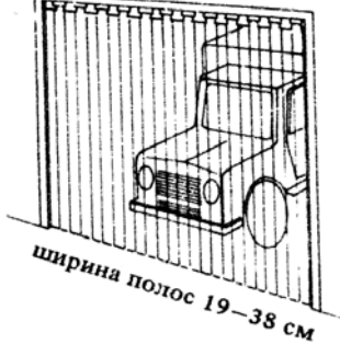
9. Полосовой занавес из поливинилхлорида для проезда машин
