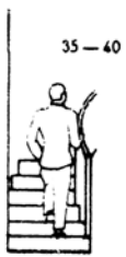
5. В узких и винтовых лестницах линия движения на расстоянии 35-40 см от тетивы
