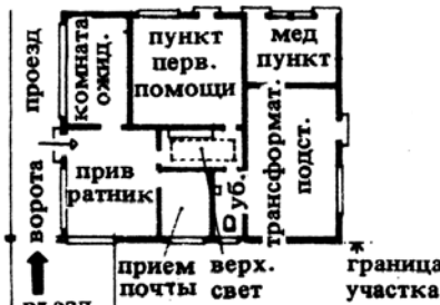
3. Проходная у заводских ворот: раздвижные ворота с подземным электрическим приводом
