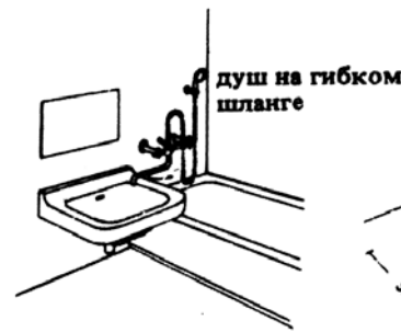
6. Общий смеситель для умывальника, ванны и душа
