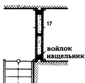
30. Замыкающие стеновые элементы и ступени перед лестничным маршем легко освобождаются от крепежных раскладок, переставляются в нужное положение и снова закрепляются
