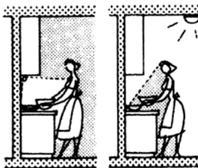
7. Правильное и неправильное устройство искусственного освещения на кухне
