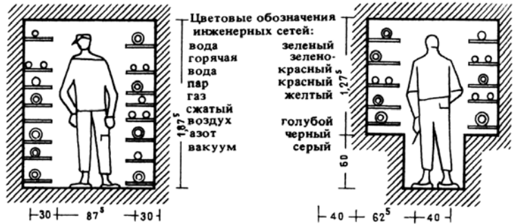
7. Сечения проходных магистральных коллекторов различны; их габариты зависят от числа проходящих трубопроводов
