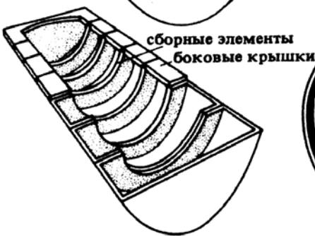
1. Сборные бетонные защитные ванны для нефтяных резервуаров емкостью 5–30 тыс. л
