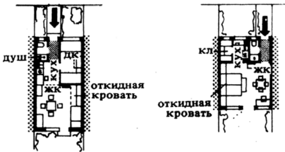
5. Узкий жилой дом с душем и уборной, нишей для приготовления пищи при жилой комнате (откидные кровати) и узкой детской комнатой на две кровати. Жилая площадь 33,2 м 2 . Архит. Х. Рихерт, г. Гданьск
