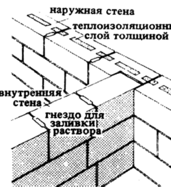
9. Кладка стены из блоков с теплоизоляционным слоем толщиной 5 см. Гнезда заливаются раствором
