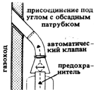
2. Предохранитель и клапан на газопроводе присоединения прибора
