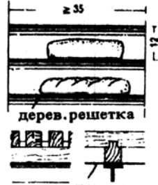
4. Устройство полок; хлеб хранится на деревянных решетках с поддоном из жести для мучной пыли
