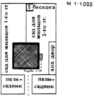
1. Проход к дому для обеих семей. Наружная лестница в подвал, в некоторых случаях — собственный проход к подвалу для верхней квартиры
