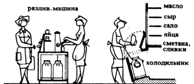
12. Охлаждаемые витрины и прилавки для демонстрации товаров. Отделение не должно влиять на их охлаждение. Иногда применяют лучистое отопление в полу торгового зала
