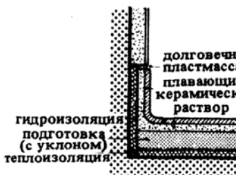
7. Плавающий пол из керамической плитки (воиные)
