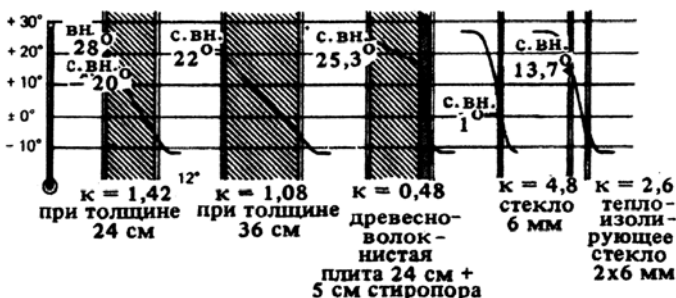
7. Распределение температур в конструкциях с различным температурным сопротивлением при t_{вн} = 28^\circ и t_n = 12^\circ . Температура внутренней поверхности стены ( t_{с.вн} ) тем выше, чем лучше термическое сопротивление
