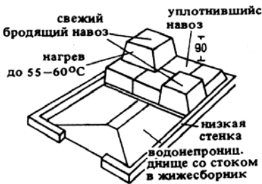
7. Вспомогательные операции для приготовления навоза по способу Кранца. Навоз настилается отдельными кучками. Благодаря возведению отсеков высотой до 3 м создается экономичное навозохранилище
