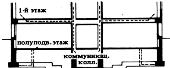
6. Коммуникационные коллекторы в бесподвальных зданиях
