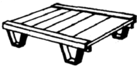
1. Погрузочная платформа (DIN 15132)
