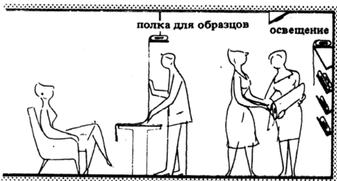
7. Прилавок для демонстрации образцов ткани с подвешенной над ним полкой для образцов и настенные полки с бортиками для показа образцов ткани
