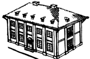
16. Стремление увеличить площадь окон в городских домах привело к замене стен каменными столбами, наподобие каркасных построек из дерева (см. рис. 10)
