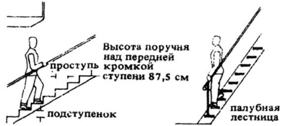
3. При наиболее удобном уклоне лестниц со ступенями 17 x 29 см ширина шага = 2 подступенка + 1 проступь = около 62,5 см
