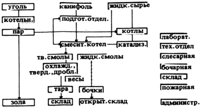
1. Схема производственного процесса химического завода
