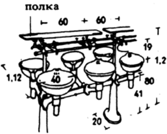
13. Новейшие двухрядные умывальники удобных размеров. Общие умывальники корытного типа уже. Ширина двухрядного умывальника этого типа 94 см (рис. 15)
