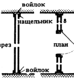
31. Замыкающие стеновые элементы и ступени перед лестничным маршем легко освобождаются от крепежных раскладок, переставляются в нужное положение и снова закрепляются
