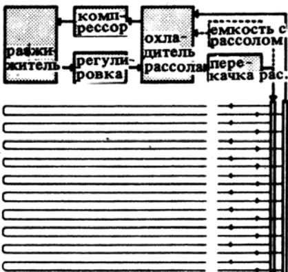
3. Искусственный каток. Схема холодильной установки
