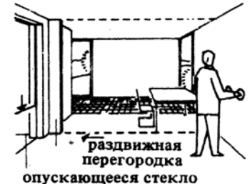
12. В XX в. в зданиях предусматривается трансформация помещений с помощью раздвижных перегородок с электрическим управлением, окна с целыми зеркальными опускными стеклами с солнцезащитными маркизами
