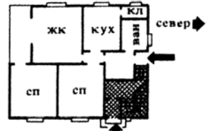
6. Несмотря на разделение дома в обеих квартирах сохранен собственный внутренний проход к лестнице, ведущей в подвал
