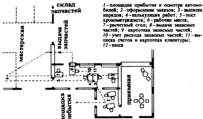
1. Целесообразное расположение помещений, соответствующее последовательности производственного процесса
