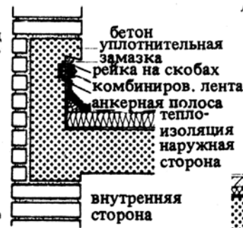
10. Примыкание к стене с помощью рейки на скобах
