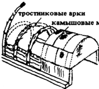
6. Наряду с куполами во многих странах получили распространение цилиндрические своды с тростниковыми арками и уложенными по ним камышовыми матами (конструкция, принятая в Месопотамии)
