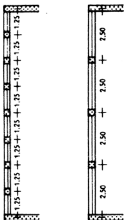
1. Целесообразные разбивки оконных проемов, отвечающие размерам парт (столов). М 1:200
