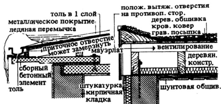
9. Карниз из сборных деталей; слишком большой свес, приточное отверстие может замерзнуть
