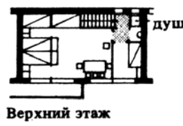
8. Жилой дом с крытыми галереями через два этажа и внутренними лестницами, ведущими с галерей в квартиру вышележащего этажа. Планировка допускает объединение квартир двух этажей в одну двухэтажную квартиру. Архит. И. В. Мум
