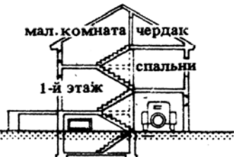
4. В этих условиях удобнее дом со смещенными этажами, полузаглубленным подвалом и гаражом на уровне земли; пол 1-го этажа значительно поднять над землей; имеется терраса и обеспечен удобный обзор ландшафта
