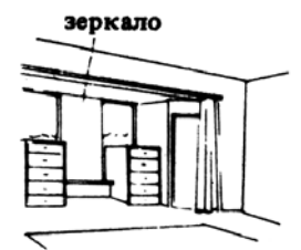
16. Перемычка и пониженный потолок в оконной нише находится на одном уровне; при задернутых занавесках образуются закрытое помещение для переоблачения (рис. 14, 15)
