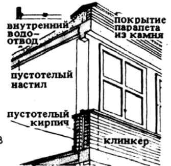
6. Железобетонное каркасное здание с подоконным поясом, прикрывающим наружные колонны на половину толщины
