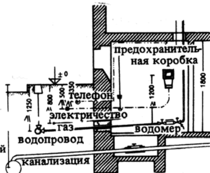
7. Разрез помещения вводов инженерных сетей
