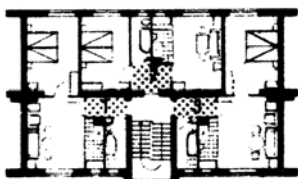
11. Секция из трех двухкомнатных квартир с кухней-нишей в общей комнате. М 1:500. Проект фирмы Дойче Хеймбау гем. АГ, Зот, Берлин
