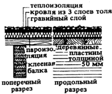
1. Теплая кровля с клееными балками. С внутренней стороны обшивка стропильными пластинами
