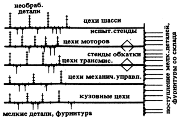
2. Схема поточного производственного процесса на автомобильном заводе
