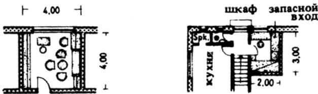
11. Комната хозяйки дома с книжным шкафом-стенкой, швейной машинкой (убирается в нижнюю часть книжного шкафа), письменным столом, комодом и местом для отдыха
