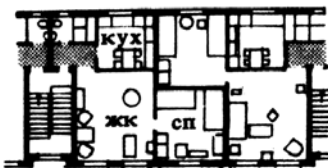
9. Двухкомнатная квартира со сменной межквартирной перегородкой, позволяющей расширить однокомнатную квартиру и превратить ее в двухкомнатную, со смежными комнатами. Такому решению присущи только недостатки. Архит. Н. Г. Фриберг
