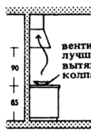
13. При отсутствии специальной вытяжки воздух, насыщенный продуктами сгорания и паром, отводят по каналу к отверстию в наружной стене. Справа разрез
