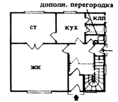
24. Если при разделении дома принимается решение об ограничении размеров квартиры первого этажа, то в первую очередь можно исключить такие помещения, как буфетная и столовая
