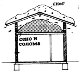
1. Разрез по сельскому для гористых местностей дому со складом корма
