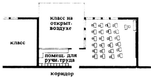
2. Блок, состоящий из класса, класса на открытом воздухе и помещения для ручного труда. Типовое решение. Архит. Нейтра
