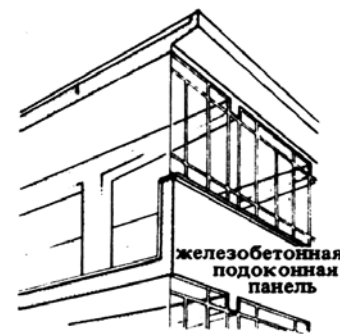
7. Железобетонное здание с целесообразным и экономичным консольным решением покрытия со сплошным ленточным остеклением
