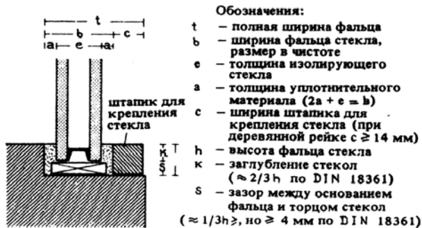
2. Установка изолирующего стекла по DIN 18361
