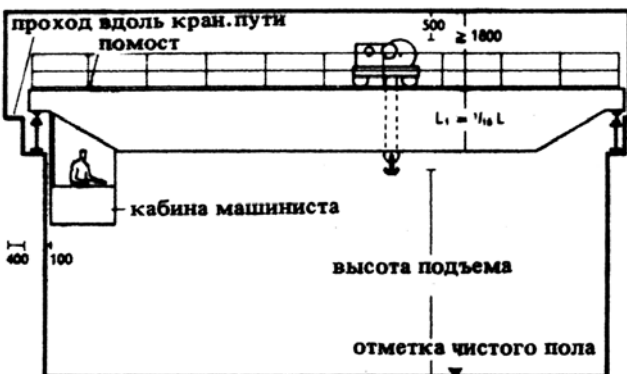
6. Мостовой кран с управлением из кабины
