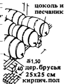
6. Размеры бочек и их размещение в погребе
