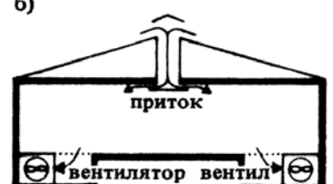
2. Система вентиляции, действующая по принципу разрежения воздуха (вытяжная)
