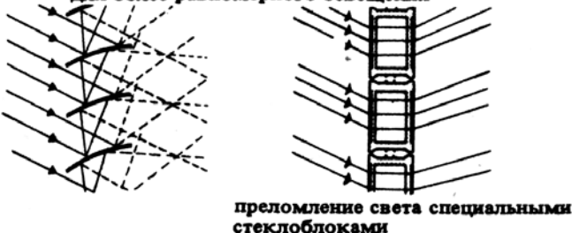
применение светопреломляющих стеклоблоков для более равномерного освещения
