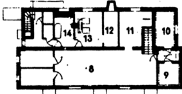
1—бакалея; 2—молочные продукты; 3—мясо; 4—склад; 5—коридор; 6—молочная кладовая; 7—кладовая для сельди; 8—склад в подвале; 9—холодильная камера; 10—кладовая для солений; 11—рыбная кладовая; 12—склад угля; 13—котельная; 14—прачечная
