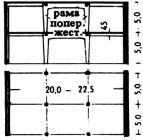
4. Наиболее широкие помещения с двумя рядами опор, обеспечивающими поперечную жесткость каркаса. Шарнирное опирание колонн наружных рядов. Рама поперечной жесткости гасит действие ветровой нагрузки
