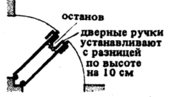
8. Правильное открывание двух дверей, ведущих в одно помещение и расположенных в углу этого помещения
