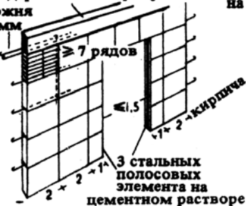
10. Армированная несущая перегородка толщиной 12 см
