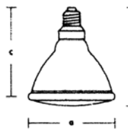
7. Лампа «Концентра» с узким и широким световым конусом (см. табл. 2)
