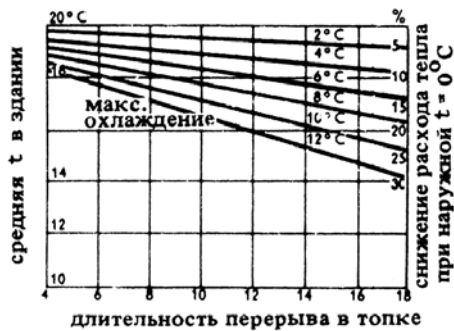
2. Экономия затрат тепла при перерывах в топке в зависимости от длительности перерыва и максимальной величины охлаждения
