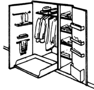
3. Гардероб с навесными лотками на внутренних поверхностях дверей (размеры см. рис. 5)
