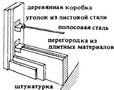
11. Крепление дверной коробки в перегородке
