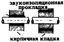
5. Изоляция труб при пропуске через стену
