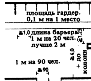
6. Выходы (§ 14 «Правил строительного надзора»), гардеробные (§ 19 «Правил строительного надзора») — см. также с. 397. М 1:200
