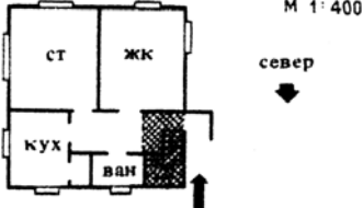
3. Типичное решение планировки дома с угловой лестницей, которая после разделения дома отделяется перегородкой от коридора 1-го этажа. Входы на чердак и в подвал открыты для жильцов обеих квартир
