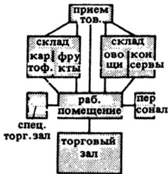
5. Схема планировки овощного магазина. Небольшой склад, рассчитанный обычно на хранение дневного запаса
