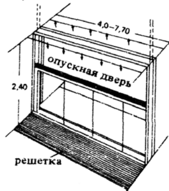
7. Опускная дверь с воздушной завесой
