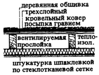
6. Холодная крыша легкой конструкции
