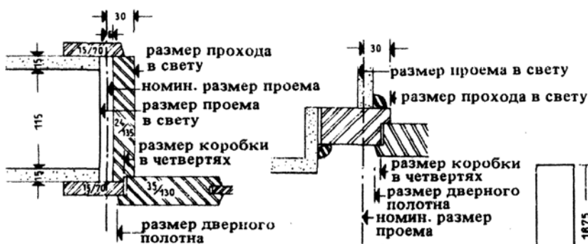
2. Дверная коробка и обработка проема в перегородках
