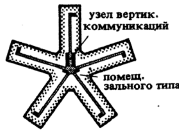
5. Пятилучевое в плане здание со срезамиными входящими углами, к которым целесообразно примыкание более крупных помещений и др. (см. рис. 6)
