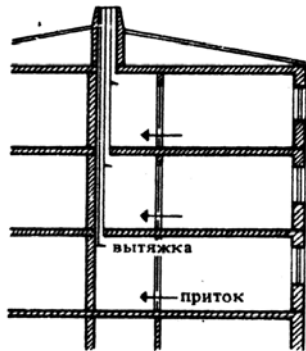
5. Вентиляционные шахты с притоком из соседних помещений
