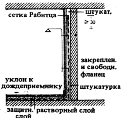
26. Гидроизоляция в душевых кабинках заводится в стену на высоту выше розетка
