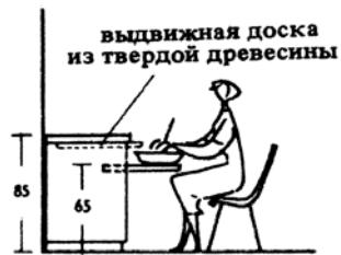
5. В кухне следует предусмотреть место для работы сидя. Лучше всего установить выдвижную доску под ящиком рабочего стола; сверху устраивается выдвижная доска для разделки продуктов
