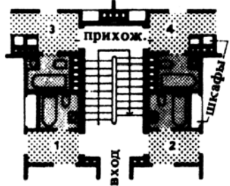
2. Планировка санитарных узлов дома башенного типа в Хельсинки (архитекторы Экелунд и Великангас)
