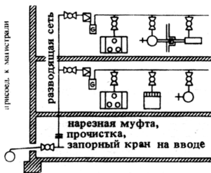
1. Схема газовой сети в двухквартирном доме
