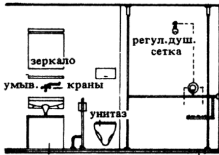
22. Развертка стены душевой кабины и разрез (к рис. 23)
