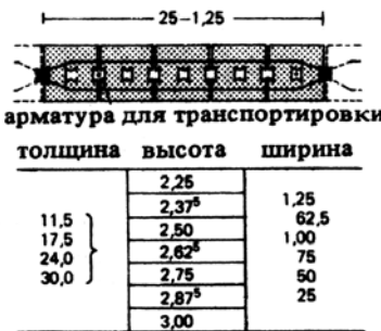
8. Размеры кирпичных панелей по рис. 5
