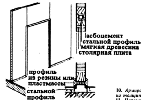
10. Армированная несущая перегородка толщиной 12 см
