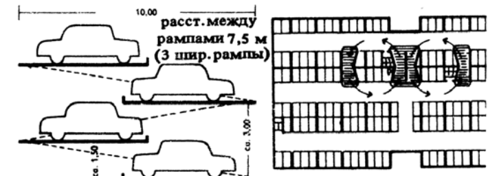
4. Американский многоэтажный гараж с рампой системы Д'Хами. М 1:2000
