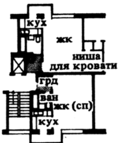
3. План датского секционного многоквартирного дома с небольшой кухней. Ванная освещается вторым светом через кухню. Архитекторы К. Фискер и Ф. Мёллер
