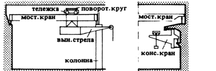
7. Мостовой кран с поворотной тележкой и выносной стрелой может обслуживать смежные пролеты или двор
