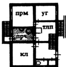
13. Прачечная в подвале дома, расположенного на горном склоне
