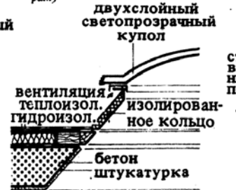
19. Двухслойный светопрозрачный купол с вентиляционными отверстиями (см. с. 116)
