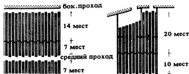
5. В том случае, когда партер расположен в уровне 1-го этажа в его боковые проходы могут выходить до 14 зрителей с мест каждого ряда, на площадке у мест выхода - до 20 зрителей с мест каждого ряда. В средние проходы может выходить вдвое меньше зрителей, чем в боковые проходы и на площадки у мест выхода
