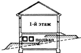
2. При небольших уклонах путем подсыпки вынуженной земли можно создать на участке террасу
