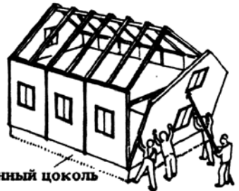
12. Применение щитов заводского изготовления сокращает сроки и снижает стоимость строительства. В Швеции применяют двухэтажные щиты (см. с. 186)
