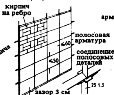
11. Перегородка-балка толщиной 6,5 см, заделанная в стены (система Прюсс)
