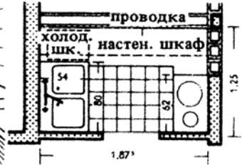
3. Минимальная кухня с вытяжкой и приточной вентиляцией (архит. Нойферт). Перспектива и план
