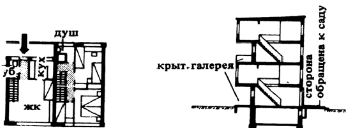
9. Франкфуртский тип жилого дома с крытыми галереями, с квартирами в двух уровнях. Второй этаж квартиры консольно выступает над находящейся под ним крытой галереей. План нижнего и верхнего этажей и разрез
