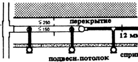
6. Трубопроводы спринклерной установки
