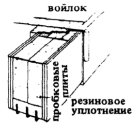
12. Звукоизолирующие двери с герметичным порогом
