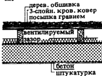
5. Холодная крыша тяжелой конструкции
