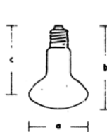
7. Лампа «Концентра» с узким и широким световым конусом (см. табл. 2)
