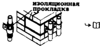
8. Изоляция труб при креплении к накладной пробке в стене
