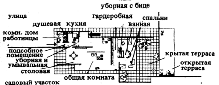
15. Дом XX в. с тонкими несущими стальными колоннами и свободно расположенными тонкими перегородками и наружными стенами, обеспечивающими надежную защиту от непогоды, звуко- и теплоизоляцию. Дверей между общей комнатой, столовой и прихожей нет
