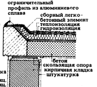
8. Скрытый край крыши (профиль «М»)
