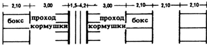
2. Коровники с боксами для беспривязного содержания скота. Кормление в коровнике. Расположение боксов по продольной оси коровника: двухрядное (а) и трехрядное (б)
