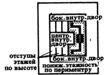
10. U-образная башенная часть здания, устроенная между двумя дворами, образованными вследствие застройки участка по периметру; нижняя и башенная части здания имеют общий сквозной узел вертикальных коммуникаций
