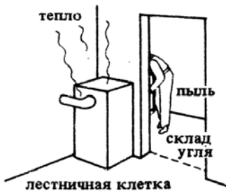
7. Котел может быть установлен в лестничной клетке с топкой из подвального помещения; при этом пыль остается в подвальном помещении, а тепло поступает в лестничную клетку
