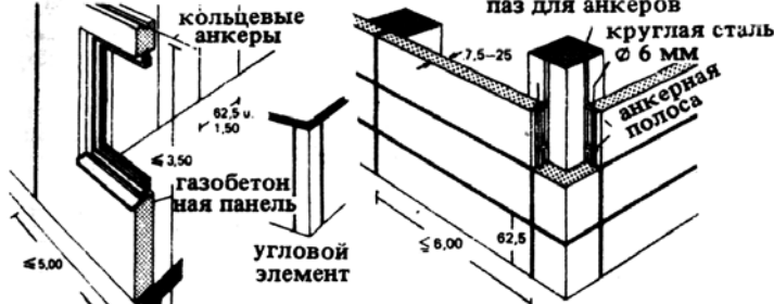
3. Газобетонные панели заанкерены к железобетонным стойкам
