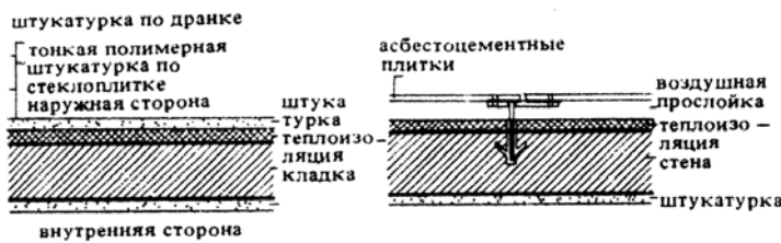
4. Сплошное покрытие с паронепроницаемым внешним слоем
