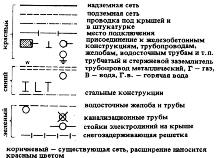
7. Снегозадерживающая решетка и водосточная труба присоединяются к отводной линии
