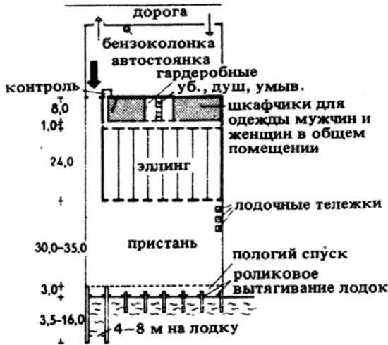
1. Схема лодочной станции на узкой береговой полосе (без здания клуба)
