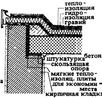
6. Край плоской крыши с закрытым швом скольжения (система «Слайд-бан»)
