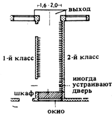
3. Гардеробная, расположенная между двумя классами. М 1:20
