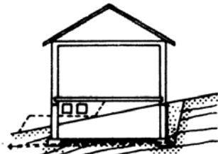
2. При уклоне обратить внимание на гидроизоляцию с нагорной стороны и отвод стекающих со склонов вод с помощью дренажа (см. рис. 5, 6)
