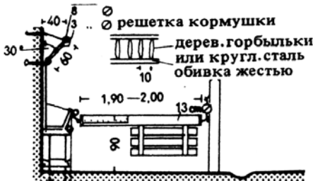
4. Устаревшая система разгораживания стойл вальками из жердей, подвешенными одним концом к кормушке, другим-к стойлу у кормонавозного прохода. Вальки в прижимающей к кормушке части обивают жестию. Лошади одной запряжки часто содержатся без разгораживания. Решетки для сена устанавливают над кормовыми корытами, идущими на всю длину стойл или между ними (см. рис. 11)
