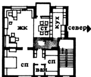
2. Решение плана жилого дома на основе схемы движения, показанной на рис. 1. Архит. А. Клейн
