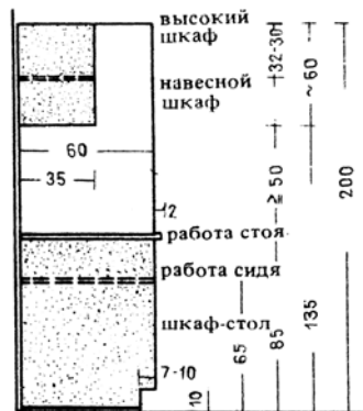
11. Разрез по кухонной мебели со стандартными размерами по DIN 68901
