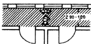
1. При односторонней застройке коридора с незначительным движением достаточна ширина 0,9 м, лучше 1 м. Расстояние между осями стен 1,25 м (см стр. 53)
