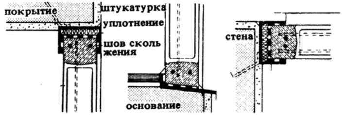
2. Детали установки стеклоблоков
