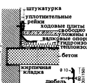
15. Примыкание стены с уплотнительными рейками (устойчивы к ударам)
