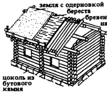
9. Во всех богатых лесами районах рубленные из дерева постройки получили большое распространение. Они имеют повсюду сходный вид, который определяется их конструкцией и материалами
