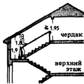
2. При совпадении направлений стропил, балок и лестничных маршей достигается экономия строительного объема здания и упрощается конструктивное решение (размеры в м)
