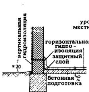
5. Гидроизоляция пола и стен
