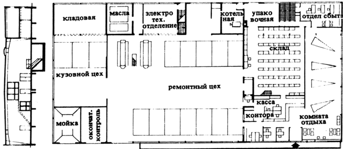
2. Авторемонтная мастерская с помещениями администрации и отделом сбыта. Поперечный разрез и план. Архит. Либиг. М 1:200
