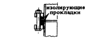
7. Звукоизолирующая прокладка в узле соединения фланцев
