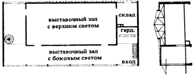
3. План и разрез картинной галереи в Дармштадте. Архит. Т. Пабст
