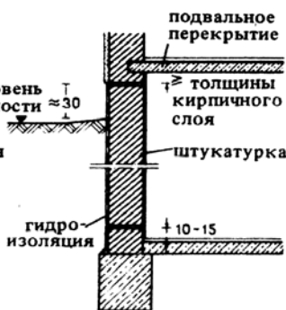
6. Гидроизоляция стен в подвальных помещениях
