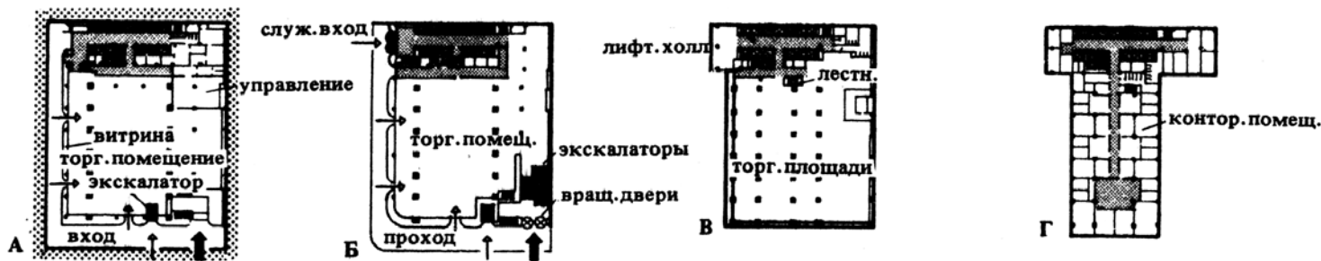
15. Планы этажей ступенчатого 33-этажного здания (США)
