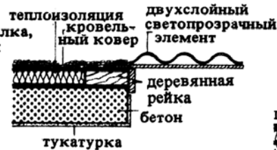
18. Разрез листового двухслойного светопрозрачного элемента с дополнительной прозрачной теплоизоляцией снизу. Пролет в свету 1 м, длина произвольна. K = 1,9 ( 1/\lambda = 0,33 )
