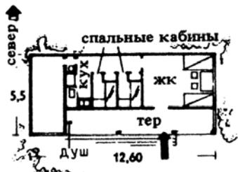
7. Дача и база отдыха на оз. Цугер Зее, рассчитанная на пребывание 6 чел. В спальнях кабинках - двухъярусные кровати. Через уборную - проход в помещение гаража. Душевая размещена на террасе, обращенной к озеру. Архитектор Х. Р. Бек и К. Мосслорф
