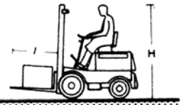
11. Старые погрузочные площадки в настоящее время заменяются автопогрузчиками, длина вилок которых 800—1400 мм
