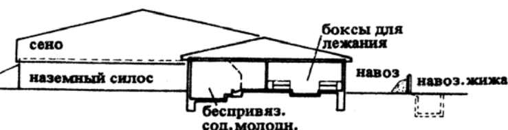
3. Коровник для беспривязного содержания 40 коров. Отсеки с боксами и кормовая площадка отделены друг от друга. (Проект Общества поселкового строительства земли Шлезвиг-Гольштейн, г. Киль). План и разрез
