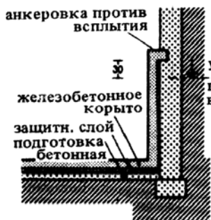
19. Устройство гидроизоляции в существующем здании
