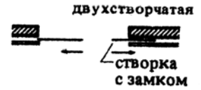
16. Раздвижная дверь, убирающаяся внутрь перегородки
