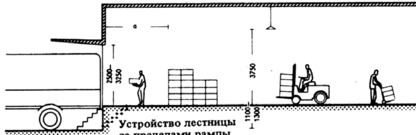
5. Подъемная площадка для подачи грузов с рампы на отметку дора
