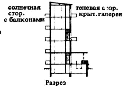
8. Жилой дом с крытыми галереями через два этажа и внутренними лестницами, ведущими с галерей в квартиру вышележащего этажа. Планировка допускает объединение квартир двух этажей в одну двухэтажную квартиру. Архит. И. В. Мум
