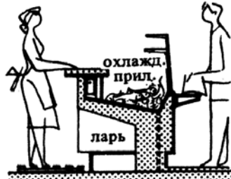
3. Охлаждаемый прилавок для продажи рыбы со стоком для воды
