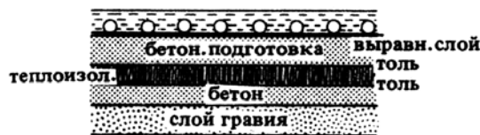
4. Деталь - трубы, уложенные поверху
