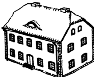
15. В дальнейшем обрамления проемов и углы зданий выкладывают из тесаного камня, а остальную часть стен выполняют кладкой из рваного камня со штукатуркой
