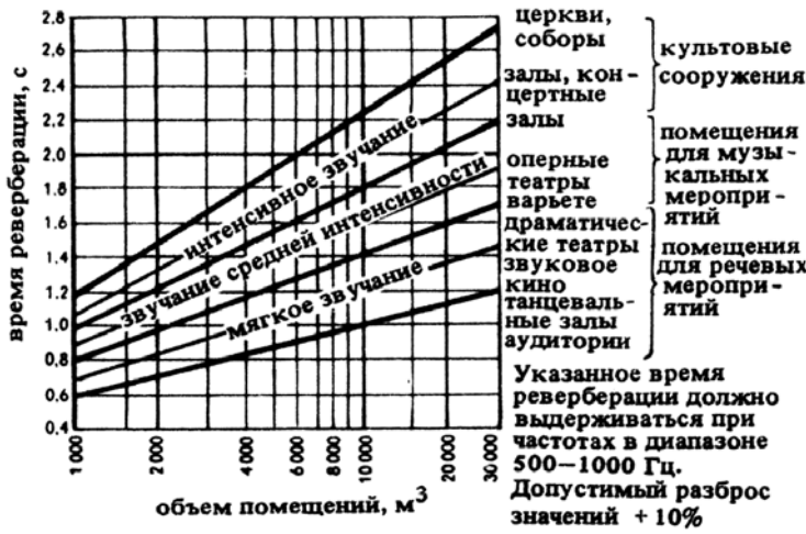
1. Зоны благоприятного времени реверберации в помещениях при их полном заполнении (по Тинхаузу)
