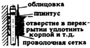
6. Изоляция труб при пропуске через перекрытие
