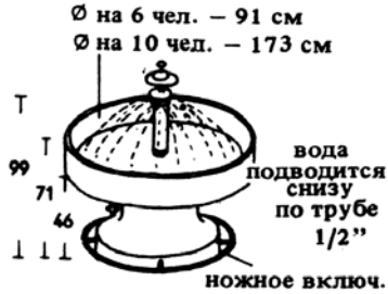
14. Круговой умывальник фонтанного типа (система Бродли) занимает на 25% меньше места, чем умывальники корытного типа. Расход воды для 10 чел. 15-30 л/мин. Напор в сети больше или равен 1/2 атм (см. рис. 17)
