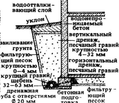
14. Трубчатый дренаж со ступенчатым фильтром
