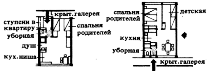
6. Ступени, ведущие с уровня пола галереи на уровень пола квартиры (см. рис. 4), размещены на площадке входной лоджии
