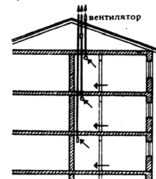
10. Индивидуальная вентиляция помещений с вытяжкой над крышей
