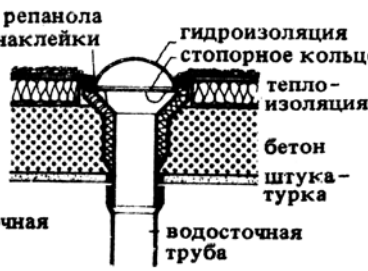
2. Впускная труба из упрочненного стекловолокном полиэфир с заводской теплоизоляцией; лучше с двойными стенками (рис. 3)
