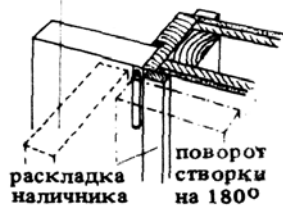
10. Дверь должна легко сниматься с петель при открывании на 90 или 180°
