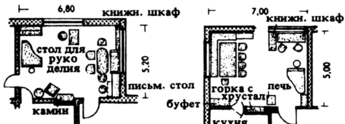
3. Музыкальная и общая комнаты с местами для занятий, рукоделия, креслом у камина и книжными шкафами (архит. Нойферт)
