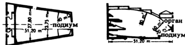
5. План и разрез концертного зала Плейель в Париже. 1927 г.
