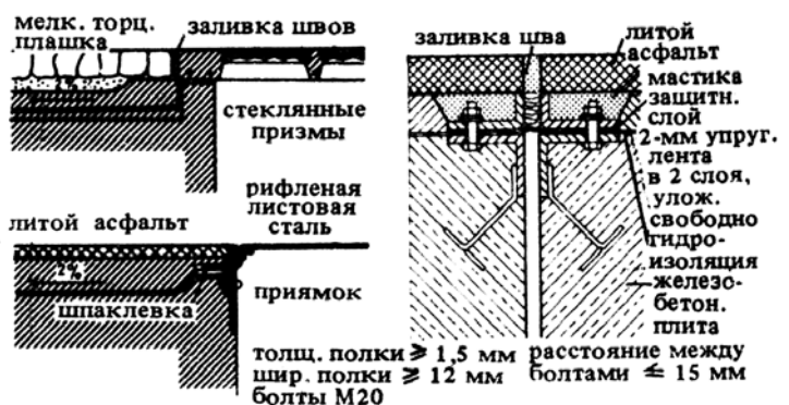
21. Гидроизоляция у световых проемов и нагрузочных поясов
