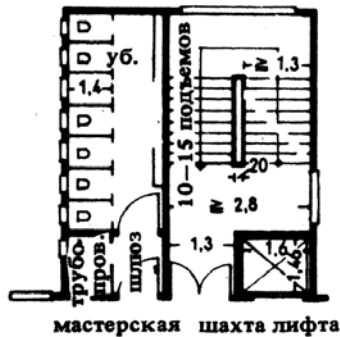
2. Обычные размеры лестничной клетки. Вход в уборную обычно устраивается также с лестничной клетки (см. с. 144–145)
