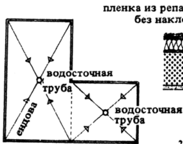
1. Удаление воды с кровли. Минимум 2 отверстия, уклон 3‰
