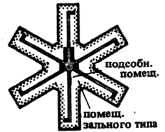
6. Шестилучевое в плане здание (максимальное число лучей для зданий звездообразной формы) с просторными, частично искусственно освещенными помещениями в его центральной части
