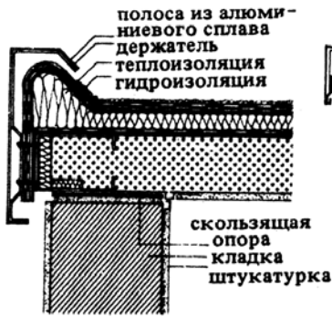
5. Край плоской крыши с открытым швом скольжения
