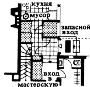
2. Кладовые в хозяйственной части жилого дома с художественной мастерской (см. с. 243). Архит. Нойферт
